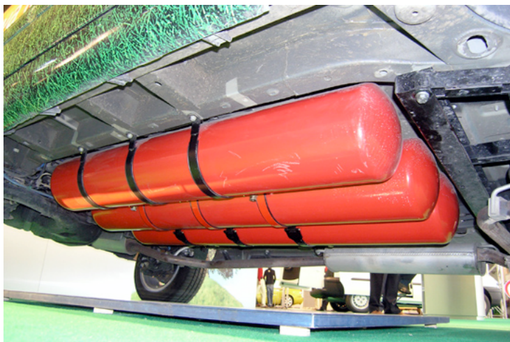
Figura: Fiat Multipla amb els dipòsits de biogàs als baixos del vehicle.
