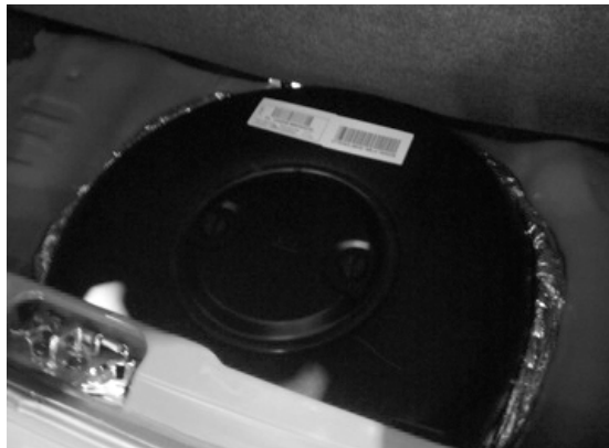
Figura 2.7. Dipòsit toroidal de GLP que ocupa l'espai de la roda de recanvi. Font: ICAEN.
