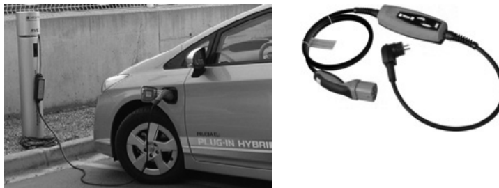
Figura 6.10. Càrrega de PHEV i cable de càrrega amb connector Schuko , en mode 2.
