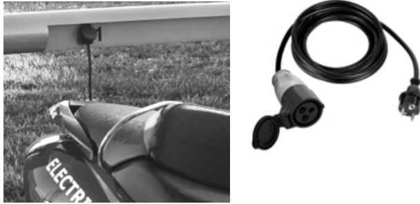
Figura 6.7. Motocicleta elèctrica carregant en pal de càrrega i cable de càrrega per a mode 1 i mode 2
